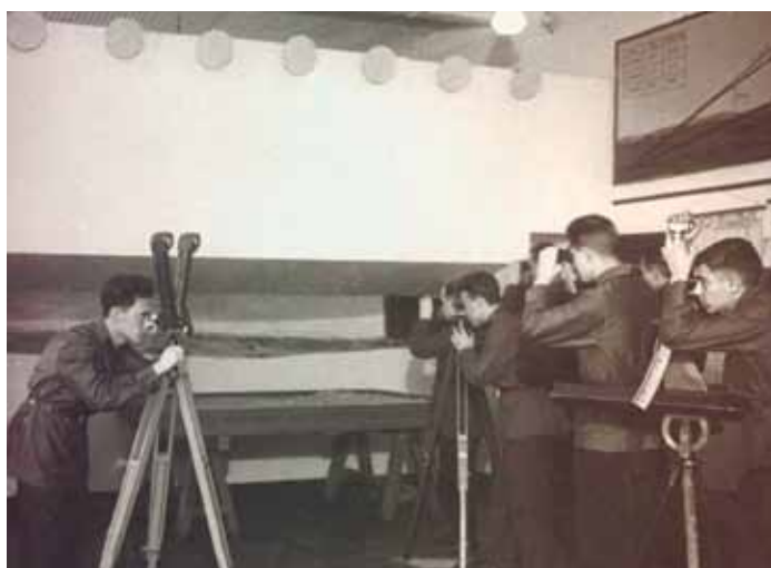
Проверка артиллерийских прицелов. Оптико-механический завод. 1940-е гг.
